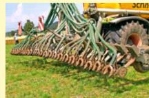
**Die Ausbringtechnik der Gülle optimieren.** Die Ammoniakverluste sind bei der Ausbringung der Gülle mit dem Prallteller am höchsten. Sie nehmen in der Reihenfolge Schlepplach, Schlepplach, Schlitzdrill (Bild) ab. Beim Güllen mit dem Schlepplach lassen sich 50 Prozent der Emissionen vermeiden. **SEITE 18**
