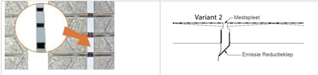
Abbildung 2: Links: SG6 Rillenboden mit einem Kunststoffsystem, das die Schlitzte teilweise verschliesst, so dass nur der Harn abfliessen kann (Quelle: Gruter_SG6_Rillenboden-web.pdf (grueter.swiss) ). Rechts: G6-Betonplatten mit Dichtungsklappen (Quelle: a8ee72_LeafletEmissiearme-plaatv.pdf (swaan-sagra.nl) 12.12.2022).
