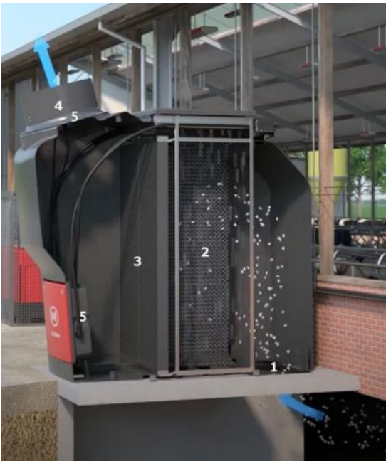
Abbildung 2. Funktionsprinzip des Lely Sphere N-Capture. 1. Öffnung zur Grube, 2. Filter, 3. Tropfenabscheider, 4. Ventilator, 5. Position für Luftstrommessung (Quelle: https://www.infomil.nl/publish/pages/130041/bwl-2021-08-v1.pdf , 31.07.2023).
