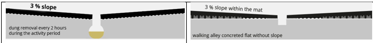
Abbildung 2: Lauffläche mit 3 Prozent Gefälle mit einer Harnsammelrinne gemäss Zähler, Schrade (2020) (links) und profiKURA-3D-Gummimatten mit 3 Prozent Gefälle mit einer Führungsrinne für den Schieber (Quelle: Potential solutions for emission reduction - KRAIBURG Practical Experience | KRAIBURG (kraiburg-elastik.com) (06.07.2022)).
