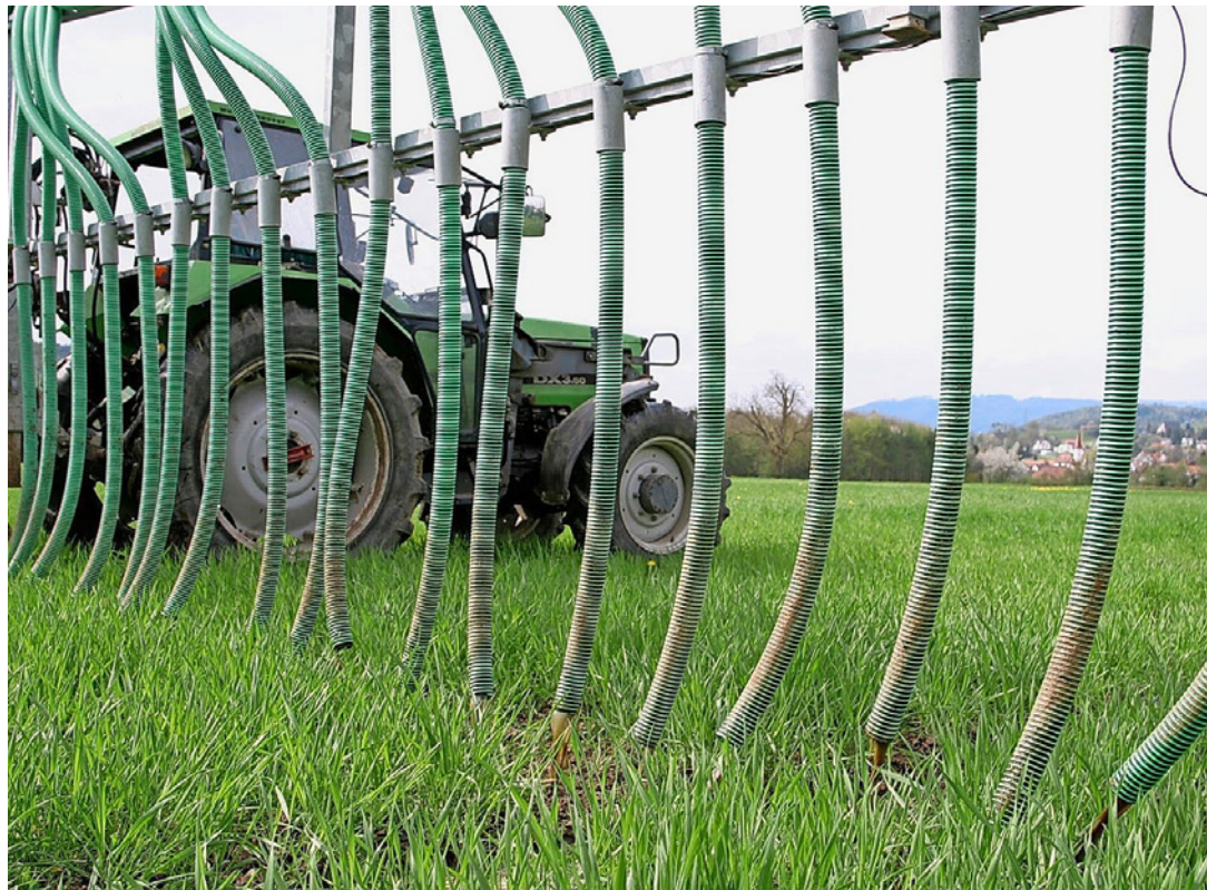
Baumeln die Enden über dem Gras, kann die Technik ihren Zweck nicht erfüllen. BILD: FIBL
